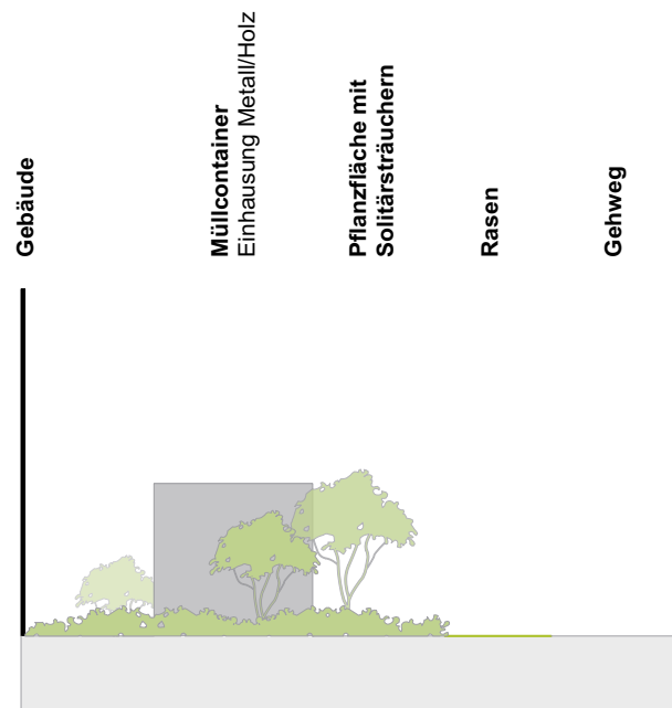
Abb. 35 Schnitt Vorzonen entlang Nebenerschließung
